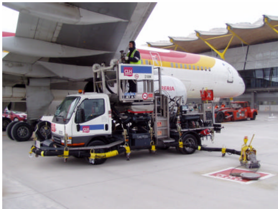
Abastecimiento de una aeronave mediante “dispenser” en el aeropuerto de Barajas
